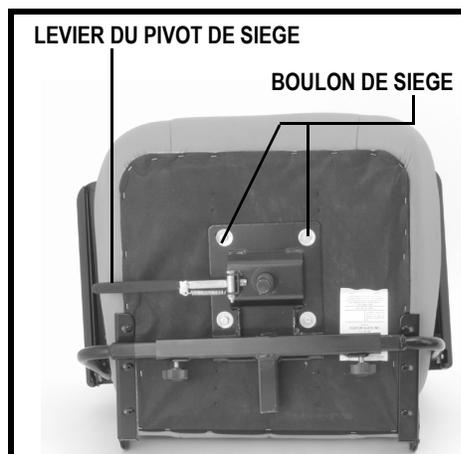
Figure 11. Réglage du siège
